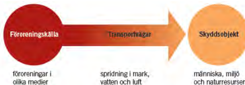
Figur 5.1. En risk föreligger när förorening från en källa (jord, grundvatten, sediment, byggnader och anläggningar) frigörs och via olika transportvägar sprids och exponerar skyddsobjekt (människa, miljö, naturresurser) så att en negativ effekt kan uppstå. (ur Naturvårdsverket, 2009a)
